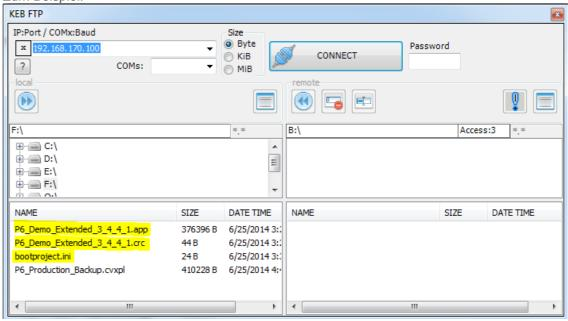
Geben Sie die P6 IP Adresse und das Passwort ein. Dann auf "Verbinden" drücken, Laufwerk "C:" der P6 Control Unit auswählen und diese 3 Dateien nacheinander an die P6 Control Unit übertragen (gleiches verhalten wie zuvor beim Löschen von Dateien: Es ist nicht möglich mehr als eine Datei gleichzeitig zu senden).
