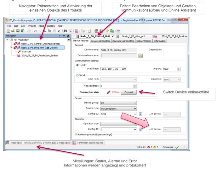
Im Geräte Editor (Doppelklick auf das Gerät) wählen Sie die richtige IP Adresse und den richtigen Port aus und klicken dann auf "verbinden". Wenn dies nicht möglich ist, müssen Sie die IP Adresse modifizieren, da das Gerät im **offline** Modus sein muss. Klicken Sie auf "trennen" und versuchen Sie es erneut. Wenn die Kommunikation aufgebaut ist, erscheint ein Grünes Symbol links von den Geräten.
